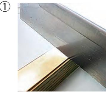
① ヘッドレールを取り付ける間口より5mm程度短めに、ノコギリでカットして下さい。
