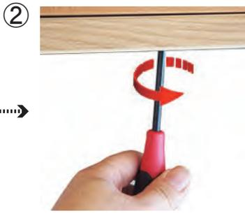
② レールを取付ます。付属のビスとプラスドライバーでレールの中央のみにビスを打って下さい。他の箇所のビスでの取付は控えて下さい。
