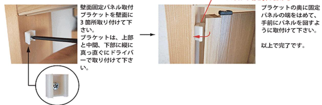
すでにパネルドアに壁面固定パネルをセットしていますので、今回はこの部分のみ作業をお願いします。
